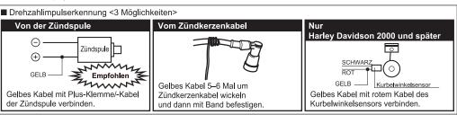
Drehzahlimpuls-Verbindung korrekt vornehmen. Falsche Verkabelung kann zu Fehlfunktionen des Instruments führen Bei unstabiler Drehzahl den beiliegenden "⑦ Widerstand 1 MOhm " in die Drehzahlimpulsleitung einfügen.
